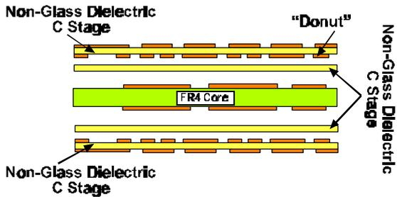
**Fig. 6 Core Cap Lamination**
